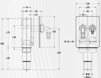
Sifone in PP ad incasso ispezionabile con 2 attacchi elettrodomestici, piastra in acciaio inox e porta gomma bianchi.
