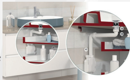
Chiusura Idrraulica 50 mm Portata 33 l/min. Prodotto conforme alla norma europea EN274
