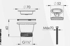
Applicazione: inox e sintetici e ceramica Materia plastica: PP, PVC e gomma Metalli: Acciaio Inox AISI 304
