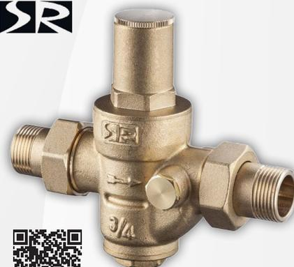
I riduttori di pressione modello Monterosa sono dispositivi regolabili in grado di ridurre e mantenere la pressione a valle impostata, anche al variare della pressione a monte. Sono tutti forniti con taratura standard a 3 bar. Questi riduttori sono costruiti con una cartuccia monoblocco, per una facile sostituzione o manutenzione in caso di necessità e possono essere installati su impianti con pressioni di esercizio fino ad un massimo di 20 bar.
