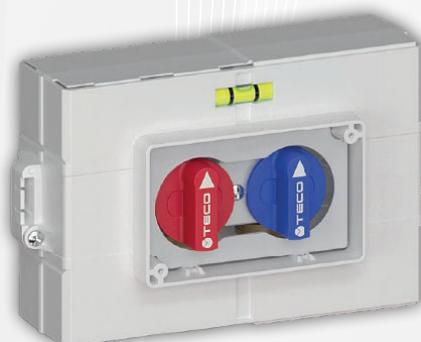
DN 15- PN 10 (10 bar). Ad incasso. Kit con doppia valvola a sfera estraibile, fredda e calda, conforme alla norma DIN EN 13828 con manovra leggera "soft turn", completo di scatola sandwich ispezionabile. Corpo in ottone con sistema Top Entry. Squadre di Fissaggio e protezione cantiere incluse. Chiusura ed apertura tramite azionamento delle maniglie. Placca di copertura apribile manualmente da ordinare separatamente, nostro codice 05737. Temperatura d'esercizio : 0°C/ +95°C.
