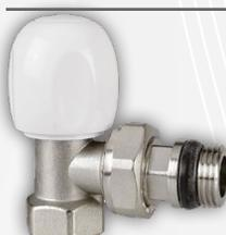
Valvola termostattabile predisposta per comando termostatico, a squadra per tubo ferro. Corredata di bocchettone antigocciolamento. Scegliere comandi termostatici ed elettrotermici con connessione 28x1,5. Fluidi impiegabili: Acqua e soluzione glicolate. Max percentuale di glicole: 50%. Pressione max di esercizio: 10 bar. Pressione massima differenziale: 1 bar. Temperatura fluido termovettore 5°C / 120°C. Corsa otturatore valvola: 3,5 mm. Connessione con teste termostatiche: M28 x 1,5
