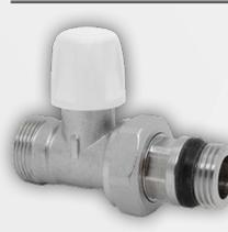
Attacco per tubo Rame, multistrato e Pe-x. Corredato di bocchettone antigocciolamento. Doppia tenuta sulla sede, O-ring più tenuta metallica. Fluidi impiegabili: Acqua e soluzione glicolate. Max percentuale di glicole: 30%. Pressione max di esercizio: 10 bar. Pressione massima differenziale: 1 bar. Temperatura fluido termovettore 5°C / 120°C.
