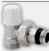
Attacco per tubo Rame, multistrato e Pe-x. Corredato di bocchettone antigocciolamento. Doppia tenuta sulla sede, O-ring più tenuta metallica. Fluidi impiegabili: Acqua e soluzione glicolate. Max percentuale di glicole: 30%. Pressione max di esercizio: 10 bar. Pressione massima differenziale: 1 bar. Temperatura fluido termovettore 5°C / 120°C.
