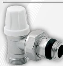
Detentore a squadra micrometrico, per tubo di rame, Multistrato, Pe-X. Doppia tenuta sulla sede, o-ring più tenuta metallica. Corredato di bocchettone antigocciolamento. Fluidi impiegabili: Acqua e soluzione glicolate. Max percentuale di glicole: 30%. Pressione max di esercizio: 10 bar. Pressione massima differenziale: 1 bar. Temperatura fluido termovettore 5°C / 120°C.
