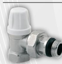
Detentore a squadra micrometrico, per tubo ferro. Doppia tenuta sulla sede, o-ring più tenuta metallica. Corredato di bocchettone antigocciolamento.
