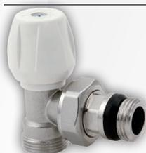
Attacco per tubo Rame, multistrato e Pe-x. Corredato di bocchettone antigocciolamento. Fluidi impiegabili: Acqua e soluzione glicolate. Max percentuale di glicole: 30%. Pressione max di esercizio: 10 bar. Pressione massima differenziale: 1 bar. Temperatura fluido termovettore 5°C / 120°C.
