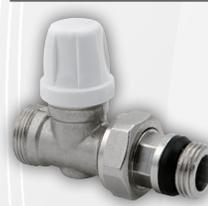
Detentore diritto micrometrico, per tubo di rame, Multistrato, Pe-X. Doppia tenuta sulla sede, o-ring più tenuta metallica. Corredato di bocchettone antigocciolamento. Fluidi impiegabili: Acqua e soluzione glicolate. Max percentuale di glicole: 30%. Pressione max di esercizio: 10 bar. Pressione massima differenziale: 1 bar. Temperatura fluido termovettore 5°C / 120°C.
