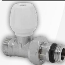
Attacco per tubo Rame, multistrato e Pe-x. Corredato di bocchettone antigocciolamento. Fluidi impiegabili: Acqua e soluzione glicolate. Max percentuale di glicole: 30%. Pressione max di esercizio: 10 bar. Pressione massima differenziale: 1 bar. Temperatura fluido termovettore 5°C / 120°C.
