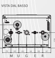
COLLEGAMENTI IDRAULICI DIN
