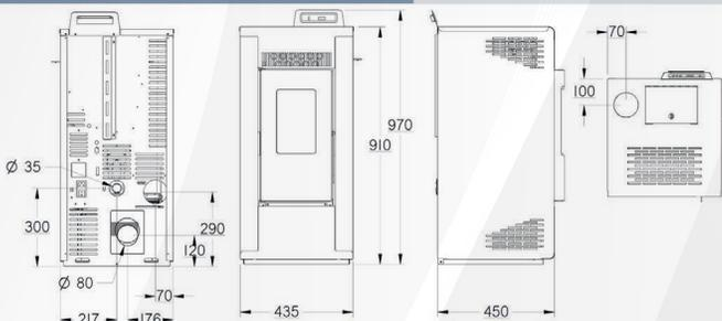
Conforme alla norma EN 14785. Rispetta i requisiti di rendimento del D.M. 16.02.2016. Rendimento termico utile 89.90%. Particolato totale PP 9,3 mg/Nm3. CO 0,23 g/Nm3 (determinato secondo la EN 14785: 2006). Rivestimento in acciaio verniciato e vetro ceramico.
