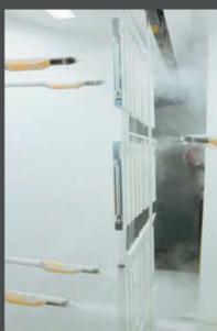
**Resistente al tempo**, prodotte in acciaio pre-zincato e protetta con verniciatura a polveri RAL 9002 di spessore medio 100 µm, resistenza a test in nebbia salina fino ad una durata di applicazione di 500 ore
