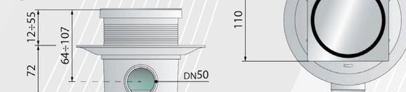
Chiusura idraulica (mm)
