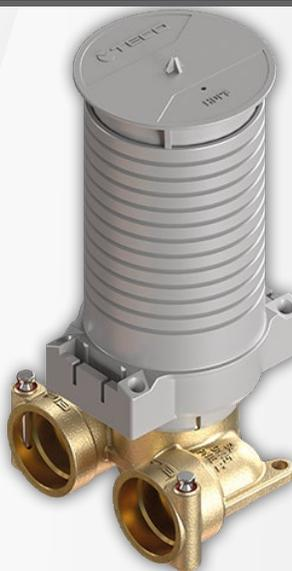
Rubinetto d'intercettazione a sfera estraibile Top Entry con passaggio totale, conformi alla norma UNI EN 13828. Sfera in tecnopolimero e guarnizioni anti-bloccaggio Soft Turn. Completo di box d'installazione tranciabile a misura, staffe di regolazione e tappo di protezione cantiere. Comandi a filo muro, esterno o interno, con manovra a 90 gradi. Finiture in quattro diverse colorazioni. Temperatura massima (picco) 95°C. Temperatura massima d'esercizio 70°C. Pressione massima 10 bar.
