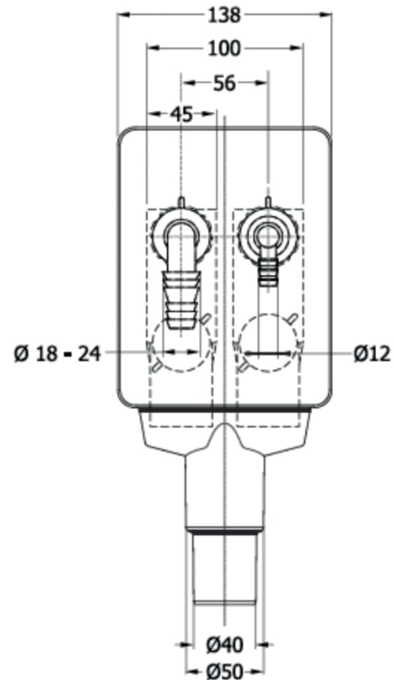
Sifone in PP ad incasso ispezionabile con 2 attacchi elettrodomestici, piastra in acciaio inox e porta gomma bianchi.
