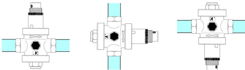
I riduttori di pressione serie EUROBRASS 146 non risentono, nel loro funzionamento, della forza di gravità; possono, quindi essere installati nell'impianto in qualsiasi posizione:
