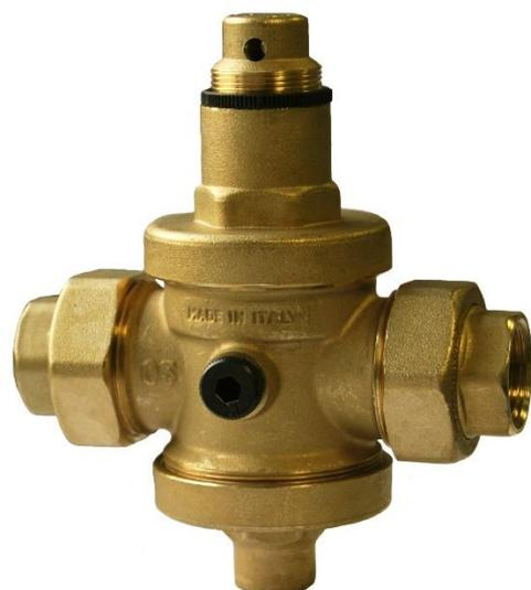
Riduttore di pressione ad azione diretta con funzionamento a pistone e sistema di compensazione della pressione
