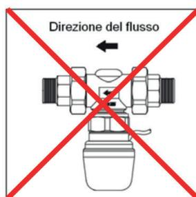
*Posizione da evitare per un corretto funzionamento dell'attuatore.*
