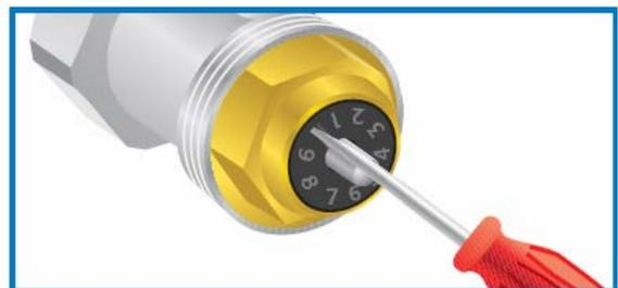
La portata settata, sarà il valore massimo di Q della valvola di zona sulla via diritta, secondo il diagramma 1.
