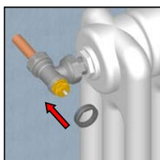
Montare la ghiera grigia fornita insieme al comando termostatico sul corpo valvola. Tenere la sede esagonale rivolta verso l'operatore.
