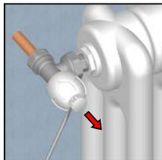
Rimuovere il coperchietto di protezione dalla manopola utilizzando un cacciavite a taglio piccolo.
