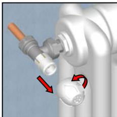
Ruotare la manopola in senso antiorario fino a sfilarla completamente dalla valvola.
