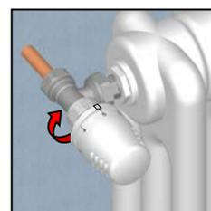
Fissare il comando termostatico alla valvola avvitando completamente la ghiera cromata sulla ghiera grigia. Serrare bene con chiave idonea.
