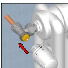
Impostare il comando sul valore 5 e inserirlo sul corpo valvola. Tenere l'indicatore rivolto verso l'alto o in posizione ben visibile.
