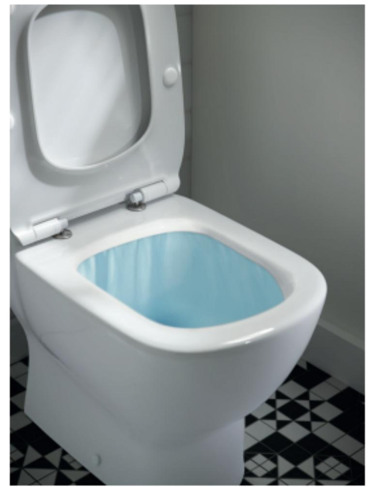
Grazie allo scarico traslato che copre distanze dal muro comprese tra i 50 e i 200 mm (attraverso le apposite curve tecniche da ordinare separatamente) può essere installato senza dover apportare modifiche agli impianti esistenti. Installazione filo parete. Il vaso è corredato di fissaggi a pavimento. Certificato per scarico 4,5/3 litri.
