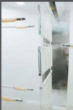
**Resistente al tempo**, prodotte in acciaio pre-zincato e protetta con verniciatura a polveri RAL 9002 di spessore medio 100  $\mu\text{m}$ , resistenza a test in nebbia salina fino ad una durata di applicazione di 500 ore
